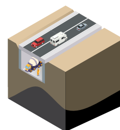
Radier réalisé en taupe sous la traverse
